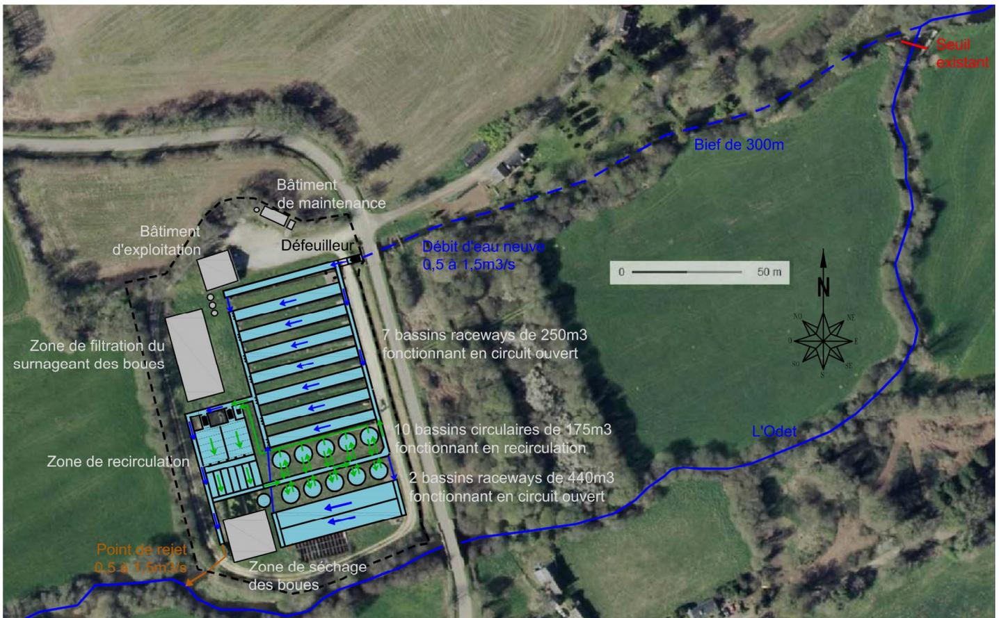
Figure 2-10 : Schéma en vue aérienne de la future pisciculture fonctionnant en circuit ouvert partiel en période de hautes eaux (source fond de carte : Géoportail)
